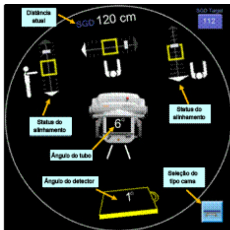
Figura 3 – O visor do tubo suspenso no sistema DRX-Revolution relata as informações da fonte de raios X em tempo real e a posição da grade/detector para o alinhamento correto.
